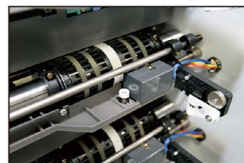
料仓上的吸气给纸部分稳定的给纸功能可适用于各种纸张。
